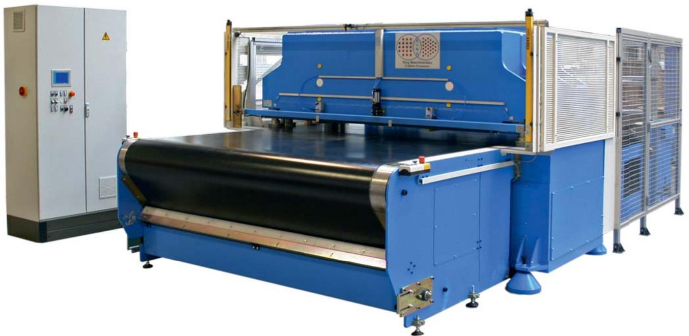
Sie ist in sehr stabiler Stahlschweißkonstruktion konzipiert. Durch Ihre Bauweise besitzt diese Maschine eine sehr extreme Verwindungsstabilität und überragende Gleichlauf Eigenschaften. Das heißt, dass die Maschine auch bei Vollast außerhalb der Tischmitte weitestgehend parallel zuläuft und den Stanzdruck ohne Verlust aufbringt.
