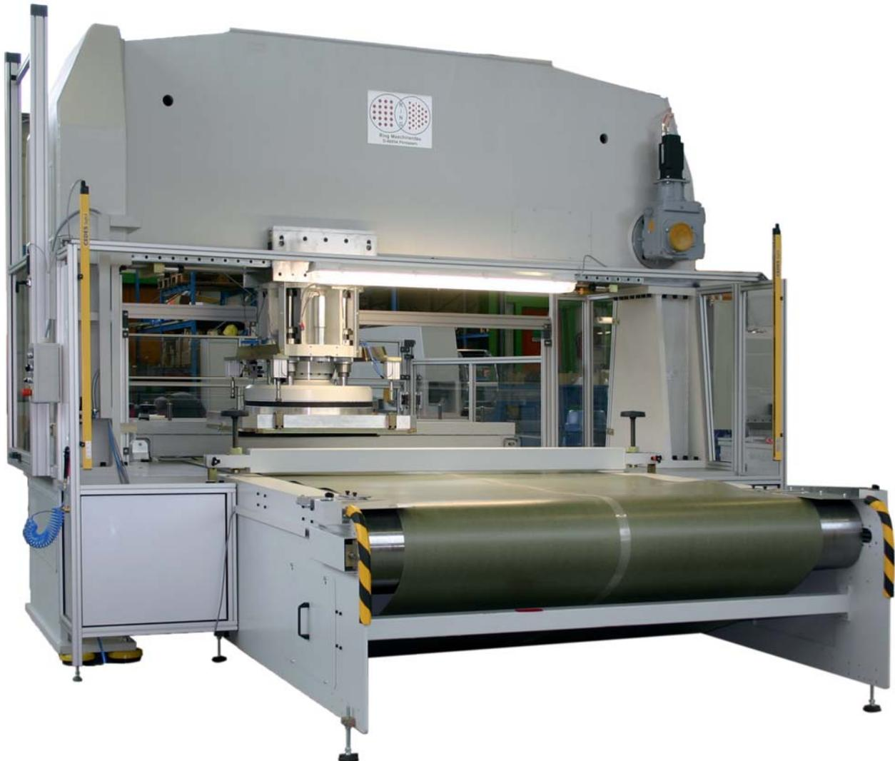
Die präzise mechanische Bearbeitung garantiert eine exakte Planparallelität zwischen Maschinentisch und Stanzkarren. Die Verfahrbewegung des Stanzkarrens erfolgt über die komplette Durchgangsbreite, durch einen servomotorisch geregelten Antrieb. Die Stanzbewegung sowie der Rückhub erfolgen hydraulisch. Zylinder und Kolben sind hierzu senkrecht in der Druckeinheit eingebaut. Die StanzmesserhöhenEinstellung erfolgt durch druckloses Absenken des Drucktellers.
