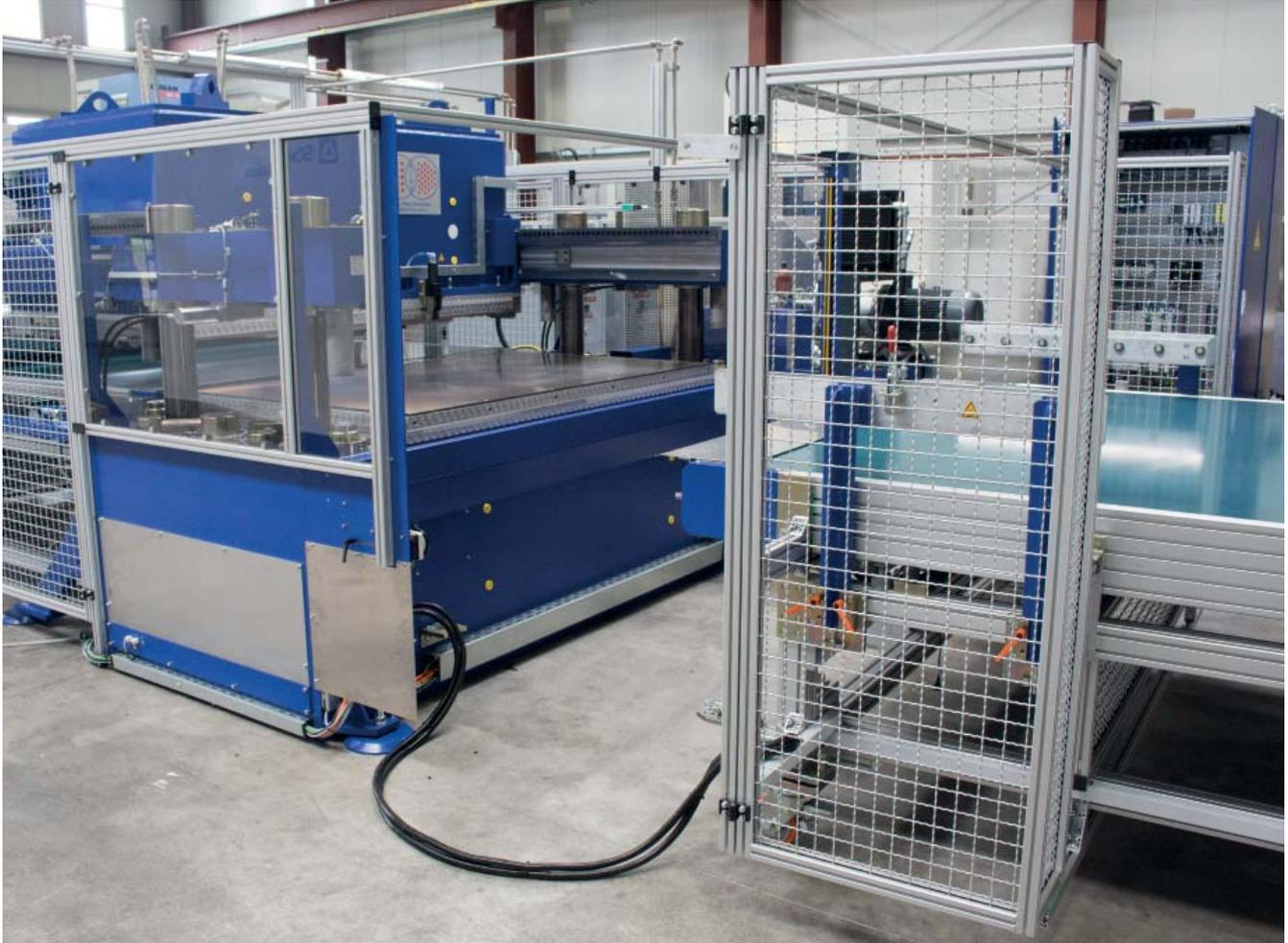
Hydraulische Großflächenstanzmaschine mit rückfahrbarer Brücke in sehr stabiler Stahlschweißkonstruktion konzipiert. Durch Ihre Bauweise besitzt diese Maschine eine sehr extreme Verwindungsstabilität und überragende Gleichlaufesigenschaften.
