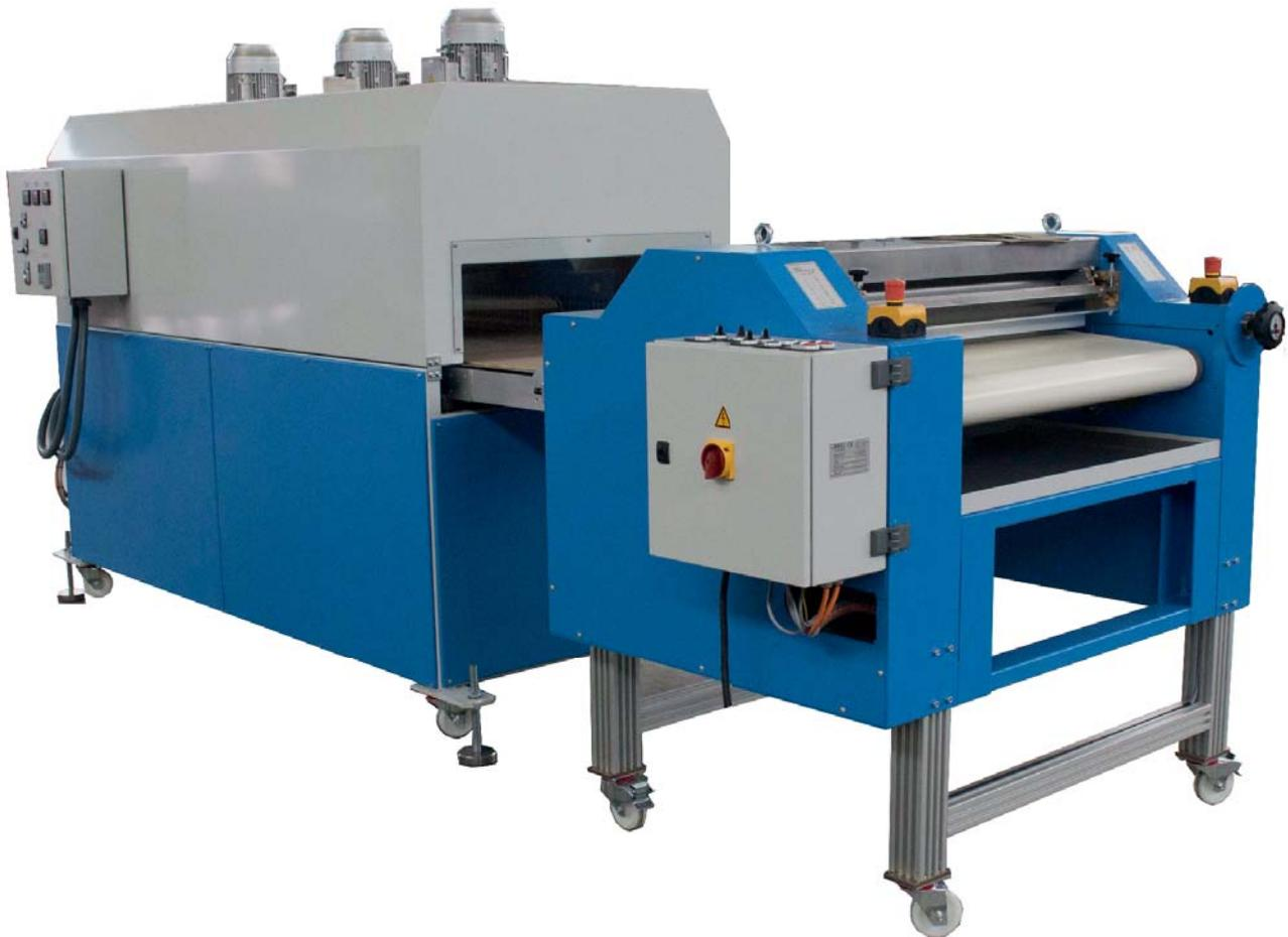
Anlage zum Auftragen von Dispersionsklebstoffen und Appreturen sowie den üblichen Lösungsmitteln mittels Gravurwalze, über diese die Auftragsmenge reguliert wird. Im zweiten Schritt erfolgt ein sicheres, schonendes, schnelles abtrockenen und ablüften der Materialien.
