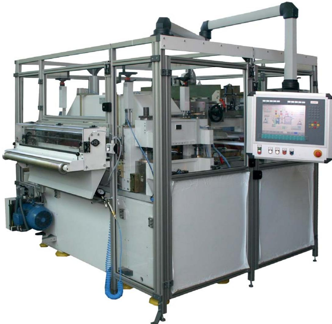
Der Schnellstanzautomat ST 90D-4S/A ist das Resultat 50-jähriger Erfahrung im Bau von Exzenterstanzmaschinen, gekoppelt mit den heutigen Anforderungen der Anwender im Bereich der Stanztechnik bei hohen Stückzahlen. Das Ergebnis ist ein modular konfigurierbarer "High-Speed"-Stanzautomat, der je nach Anwendung und Ausführung bis zu 300 Takte pro Minute erreicht. Er eignet sich zum Stanzen gegen Stahl, Kunststoffstanzband und ist als Highlight Kiss-Cut fähig.
